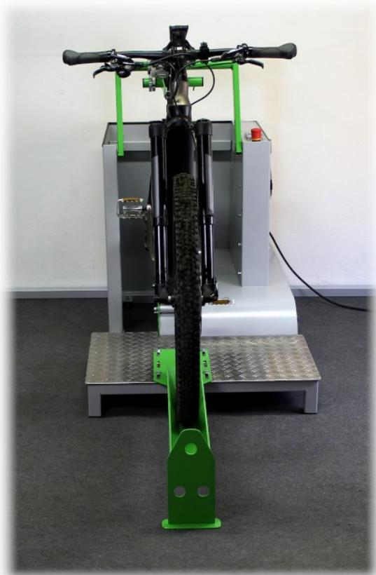
Durch das neu entwickelte Balancing-Verfahren, werden Störeinflüsse, wie Reifendruck, Fahrgewicht, usw. zuverlässig eliminiert.
